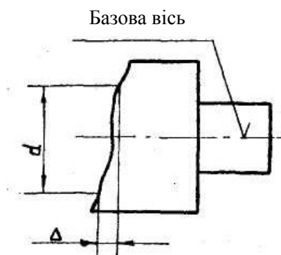
Рисунок 1.4—Схема до визначення торцевого биття
