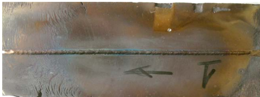
Рис. 1. Внешний вид образца со швом жаропрочного титанового сплава с повышенным содержанием алюминия, выполненного ЭЛС
