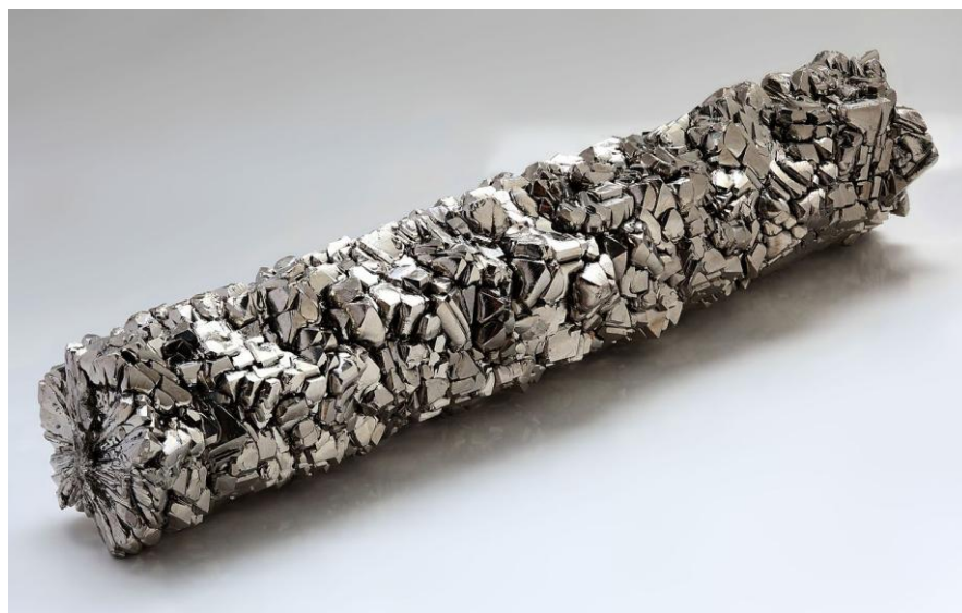
Рисунок 5.1 – Стрижень титанових кристалів високої чистоти (99,995 % Ti)
