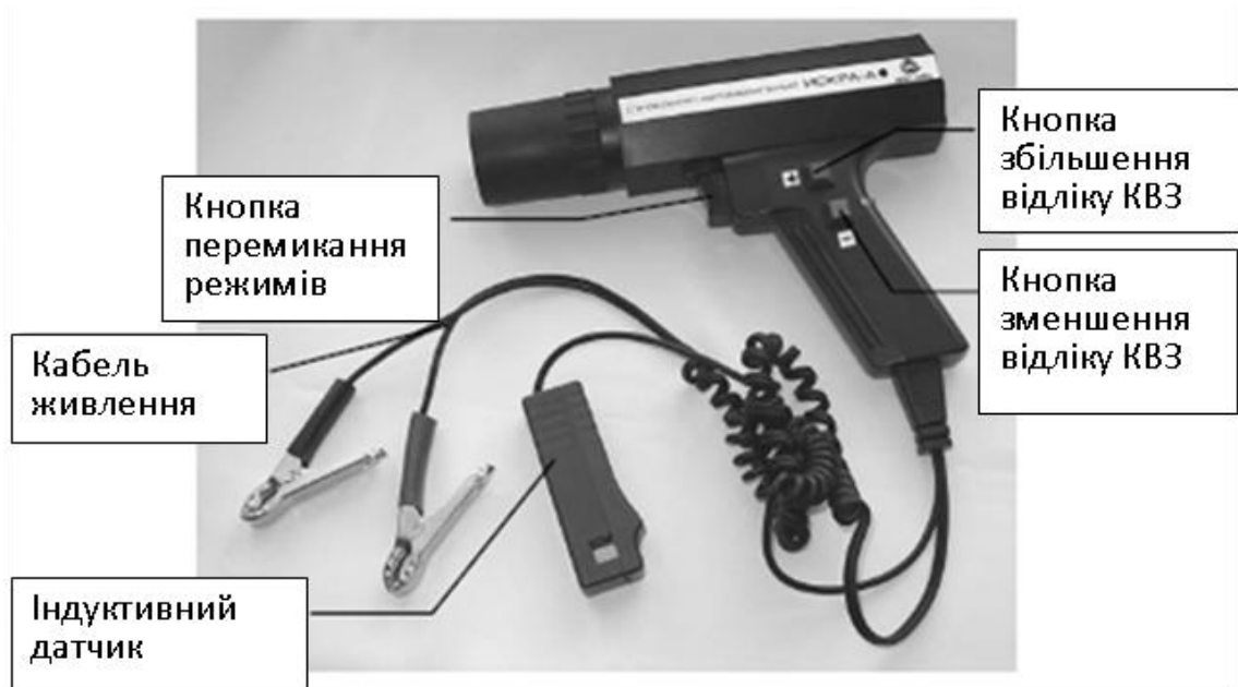
Рисунок 3.1 - Загальний вигляд стробоскопа «Іскра-А»
