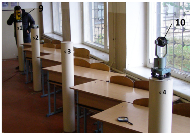
Рис. 1. Вимірювання відстаней за допомогою тахеометра Trimble 3305 DR
