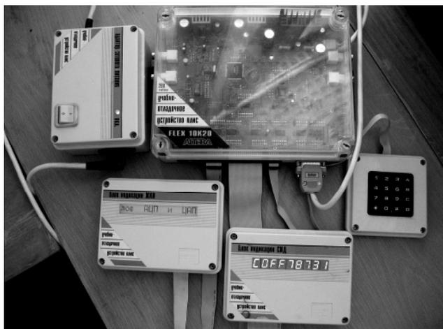
Рис. 1. Отладочный модуль ПЛИС Altera.
