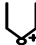
Рис. 2.1 – Умовне графічне зображення термоелектричного перетворювача
