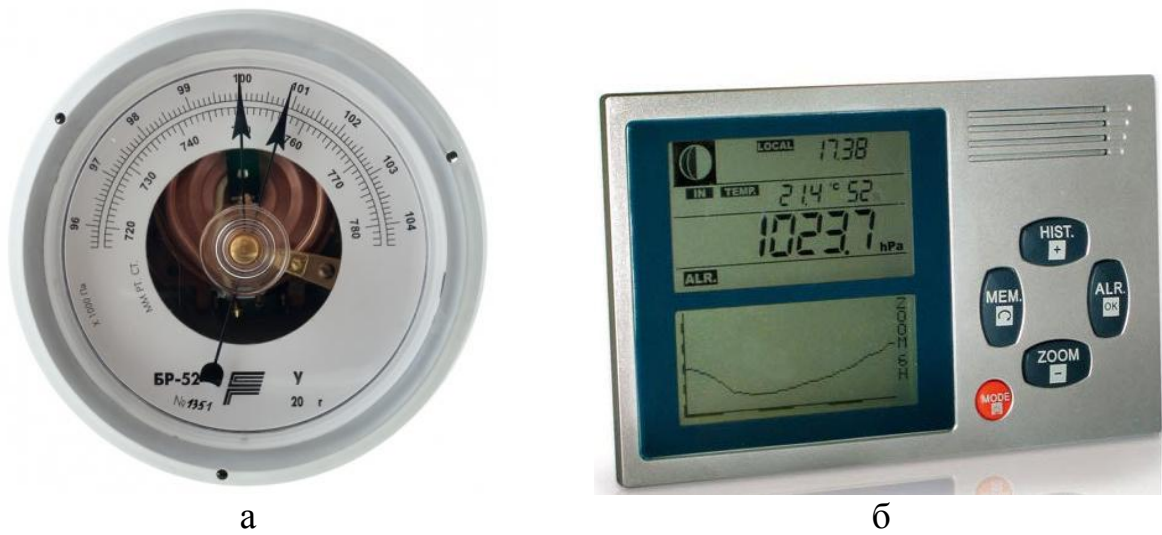
Рисунок 1.4 – Барометри: а – барометр-анероїд, б – цифровий.
