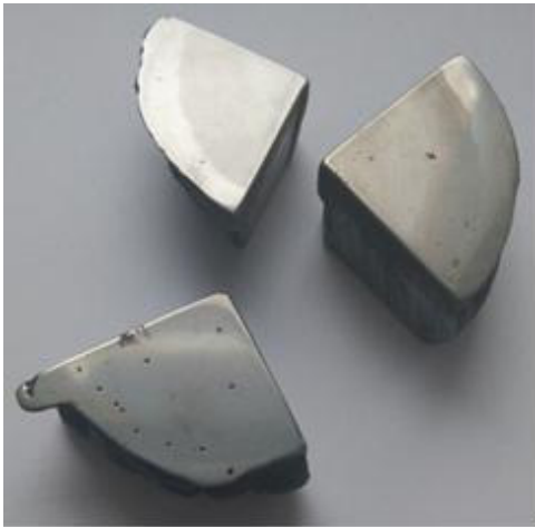
Рис. 1 – Зразки для вимірювання твердості і вивчення мікроструктури
