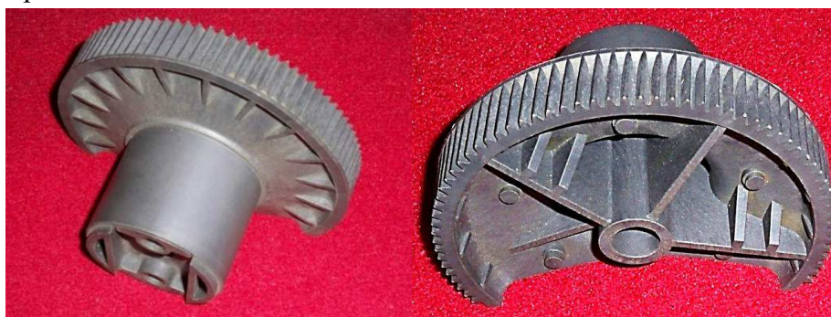
Рис. 21. Косоzubий сегмент колеса, що працює в парі зі сталевим черв'яком
