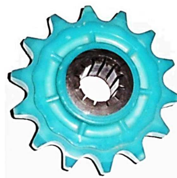
Рис. 8. Пофарбована натяжна зірочка з підшипником ковзання з САМ
