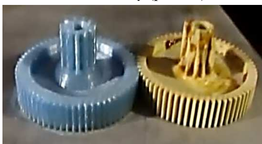
Рис. 28. Зруйнована шестерня (праворуч) та відновлена на 3D принтері (ліворуч)
