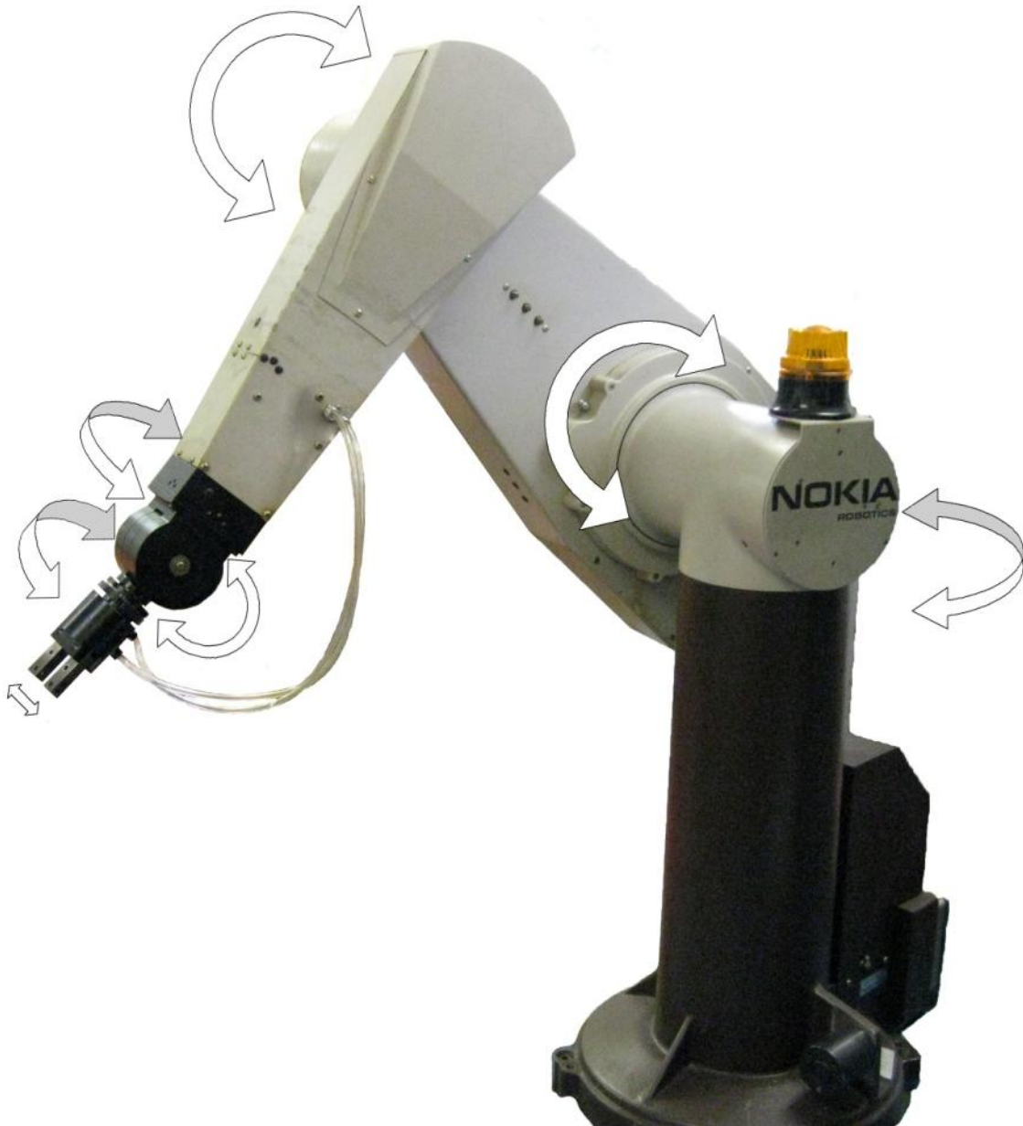
Рисунок 4.1 – Схема рухів робота РМ-01
