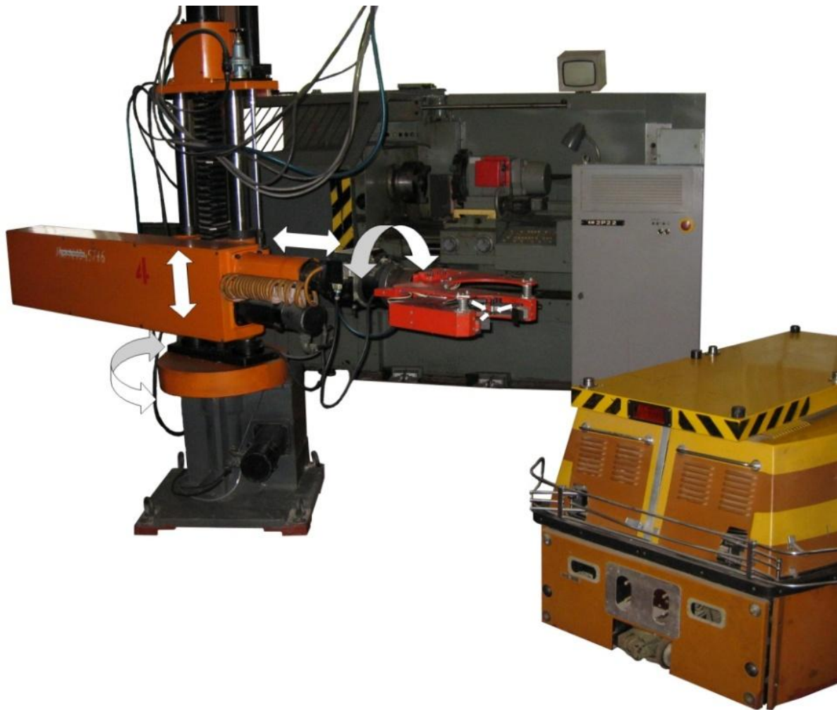
Рисунок 3.1 – Схема рухів робота МП 20.01
