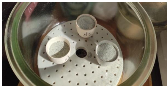
Рис. 2. Кислотно-активований висушений сорбент
