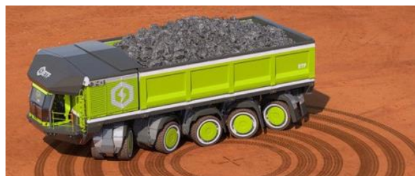
Рис. 8 – ETF Haul Train розвертається навколо своєї осі
