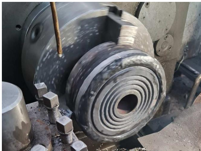
Рис. 3 – Механічна обробка пресової шайби на токарному верстаті
