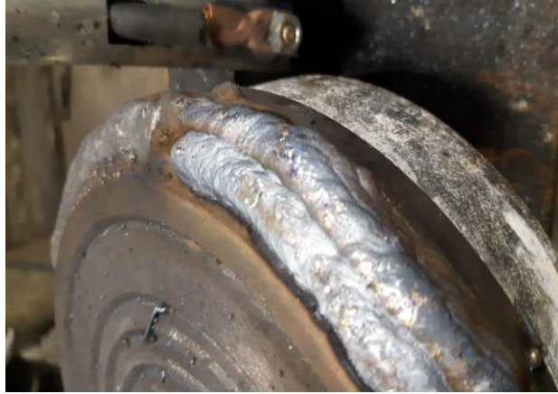
Рис. 2 – Загальний вигляд напавленої поверхні пресової шайби діаметром 205 мм.
