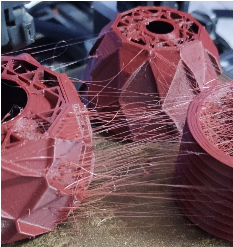
Рисунок 2.4– Приклад невідповідності налаштувань друку і рекомендацій виробника
