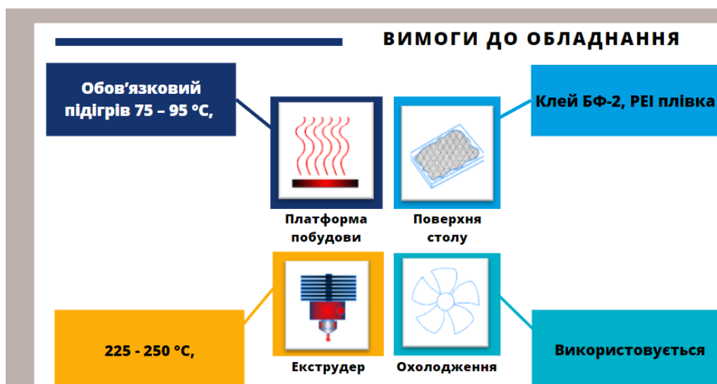
Рисунок 2.4– Приклад невідповідності налаштувань друку і рекомендацій виробника
