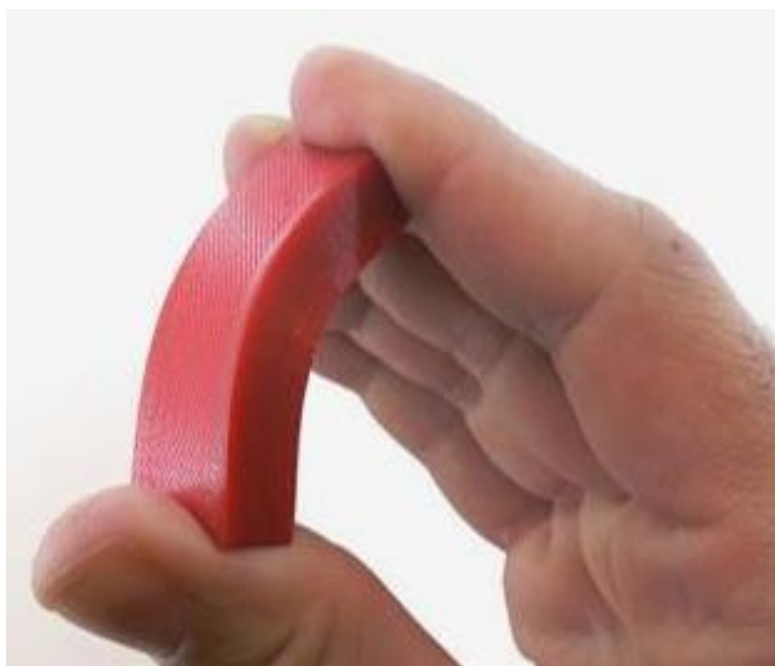
Рисунок 2.5– Ілюстрація гнучкості TPU від tractus3d.com
