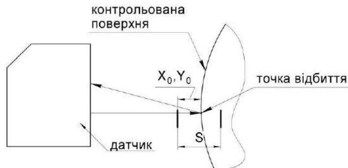
Рисунок 3.16 - Схема визначення початкового положення точки відбиття лазерного променя
