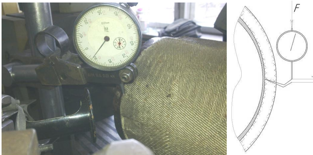
Рис. 6. Визначення сили протидії повстини деформації голки
