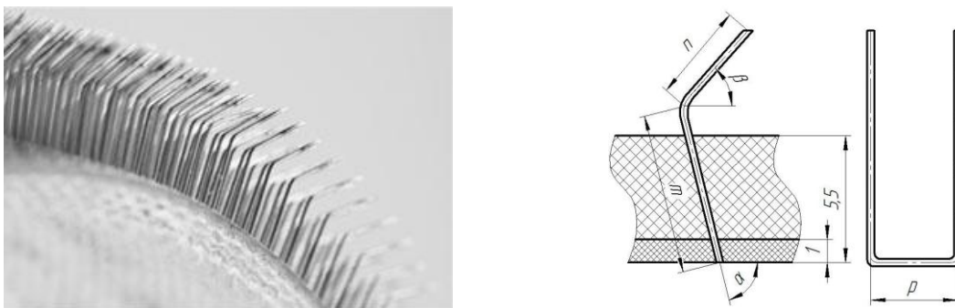
Рис. 1. Загальний вигляд та основні розміри голчастої гарнітури
