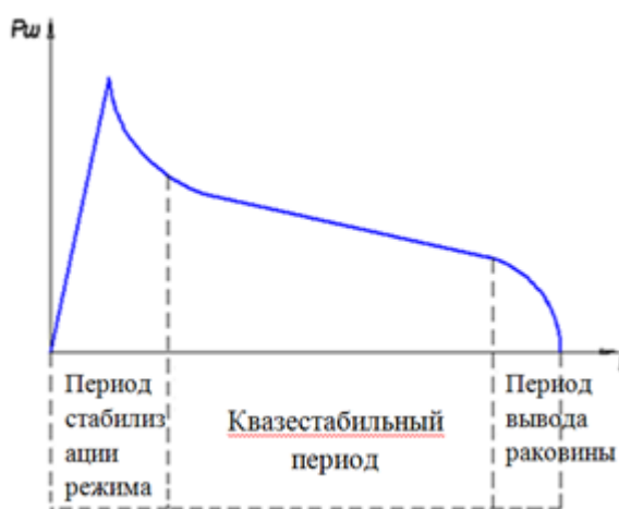
Рис. 1. Изменение мощности ЭШП при плавке
