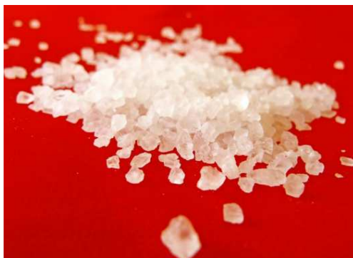
Рис. 3.47. Зовнішній вигляд бішофіту
